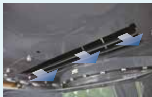
Uitstoot uit de uitlaatdemper en koelventilator van de motor
