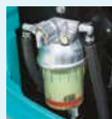
Voorfilter met ingebouwde water-afscheider
