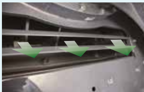
Gebogen afvoerkanaal vertraagt de uitstoot
